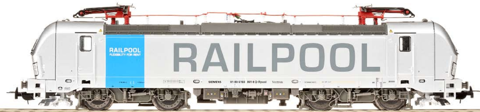
Sehr gut ausgeführt sind die Drehgestell-details, während die angeformten Griffstangen die Optik etwas stören.
