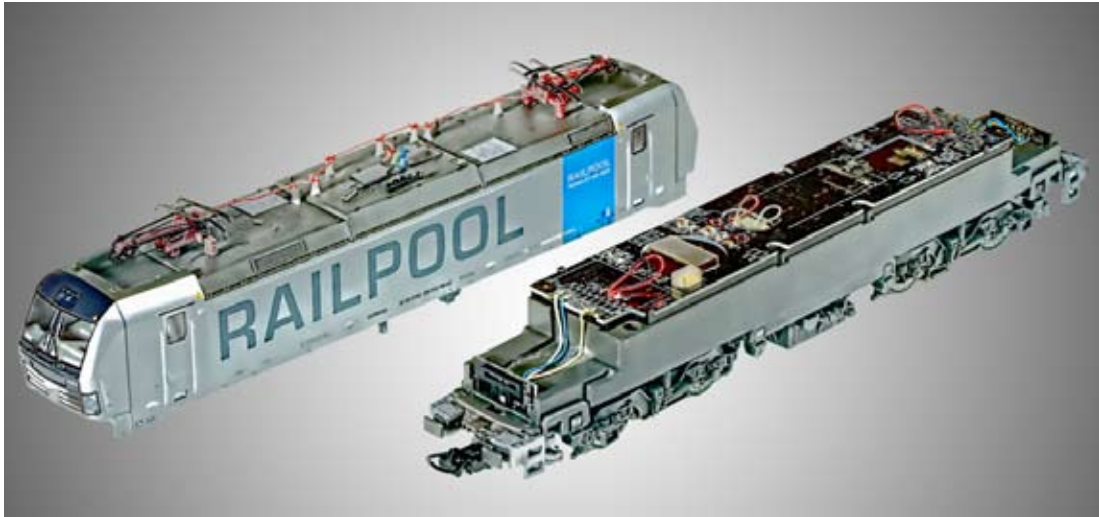
Aufgeräumtes Interieur: Nach dem Lösen von vier gut kaschierten Kreuzschlitzschrauben seitlich unter den Drehgestellen kann das Lokgehäuse problemlos nach oben abgezogen werden.
