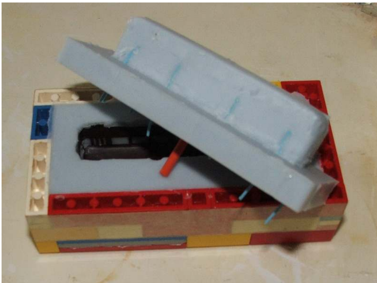
Slika 18. Razdvajanje dijelova kalupa.
