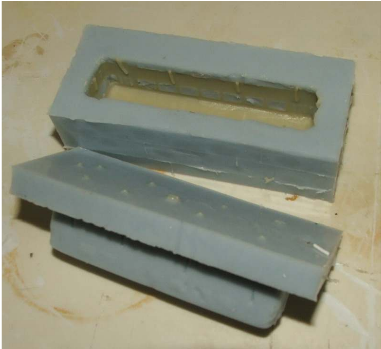
Slika 22. Nepotpuno osušeni odlijevak.
