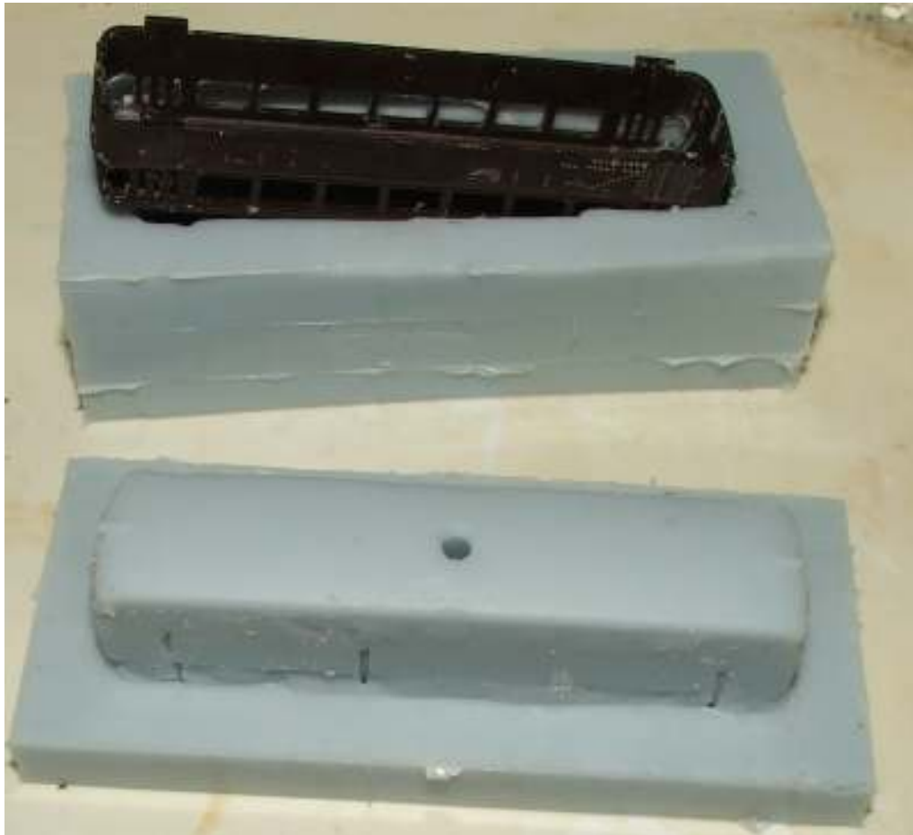
Slika 19. Zgotovljeni kalup.
