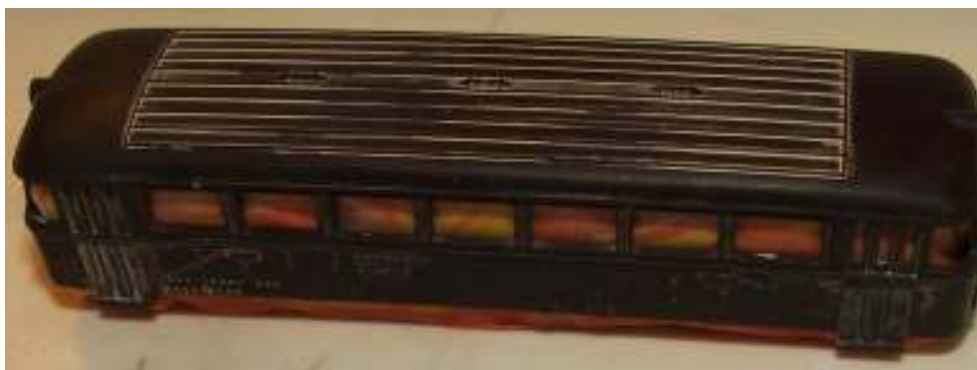
Slika 7. Punjenje izvornika plastelinom.
