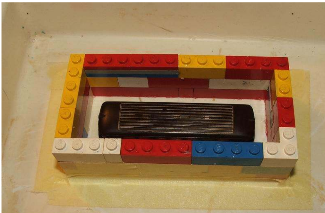
Slika 9. Kućište kalupa zajedno s izvornikom.
