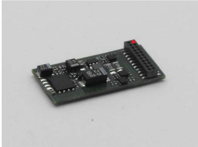
Der mit Rot gekennzeichneten Anschlußpunkt ist der sog. Index-Fuß. In der Lok befindlichen Platine wird diese Pin ausgeschnitten.
